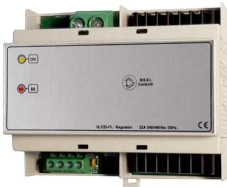
Relè statico monofase zero-crossing per il controllo di carichi monofasi resistivi stabili. Acquisizione automatica segnale 0-10V o SSR 11-24V. Con controllo 0-10V conversione a tempi proporzionali veloci con tempo di ciclo 0,4 Sec. Due Relè statici incorporati 22A a 45°C temperatura ambiente. Adatto a controllare carichi resistivi come lampade ad infrarosso a onde medie .
